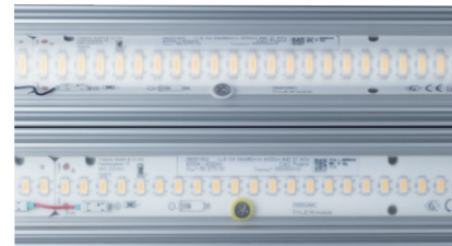
A lámpákba megbízható, Samsung LM301B LED szalagok vannak beépítve, amelyeknél a színhőmérséklet 2700 – 6500K tartományban állítható be. A lámpák optikai rendszere segítségével különböző sugárzási karakterisztikákból lehet választani.
