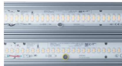
Svítidla používají spolehlivé LED pásy Tridonic LLE G4 ADVANCE s volitelnou teplotou chromatičnosti 3000-6500 K. Optický systém umožňuje výběr z celé řady vyzářovacích charakteristik.
