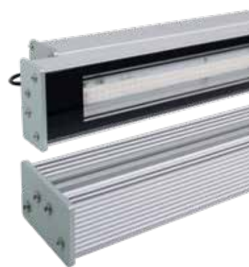
Speciálně navržené hliníkové tělo zajišťuje účinný odvod tepla i v horkých letních měsících. Naopak v zimních měsících, v případě pokrytí svítidla ledem, námrazou či sněhem je automaticky spuštěn unikátní systém vyhřívání předního krytu svítidla.
